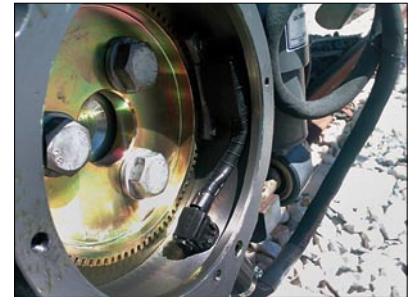
4. ábra Házra szerelt AXLETRONIC érzékelő
