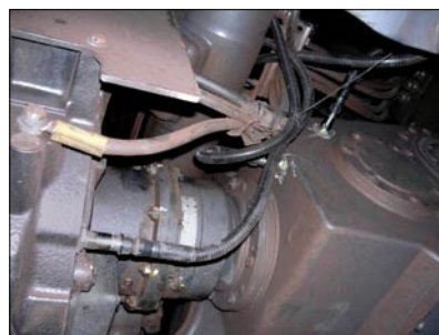
8. ábra A barcelonai metró AXLETRONIC érzékelővel felszerelt hajtórendszere Abbildung 8. Mit einem SKF Axletronic Sensorsystem ausgestattetes Antriebssystem der Metro von Barcelona Figure 8. Barcelona Metro drive system equipped with an SKF Axletronic sensor system
