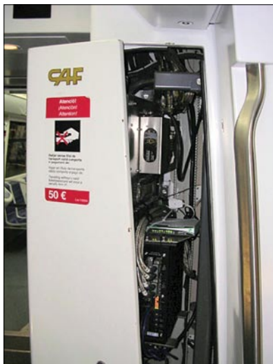
7. ábra A barcelonai metró számos kocsiját SKF állapotfelügyeleti egységekkel szerelték fel Abbildung 7. Einige Wagen der Metro von Barcelona sind mit SKF Zustandsüberwachungseinheiten ausgestattet Figure 7. A number of Barcelona Metro coaches are equipped with SKF condition monitoring units
