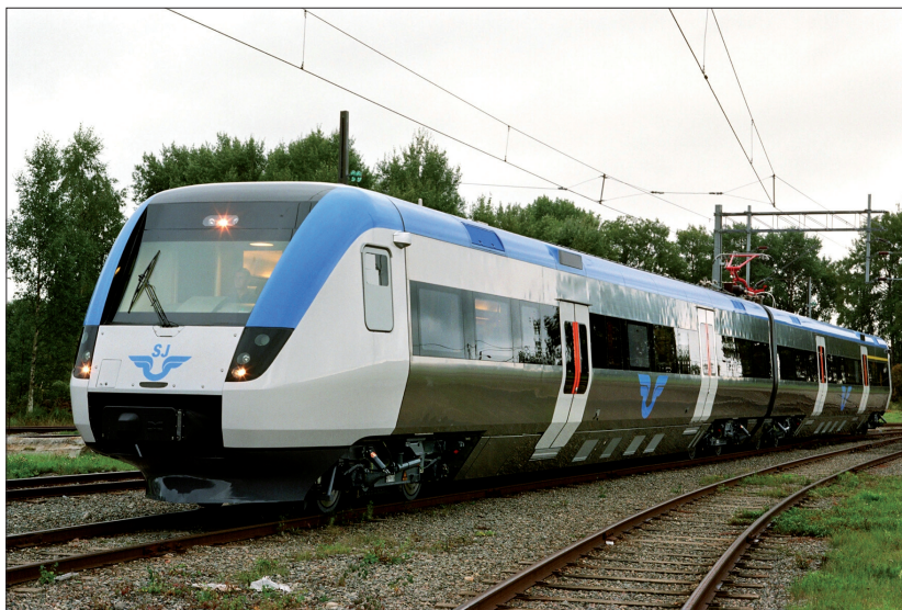
28. ábra A Bombardier Regina típusú svéd megrendelésre gyártott motorvonata a Stage III.B környezeti normát teljesíti
