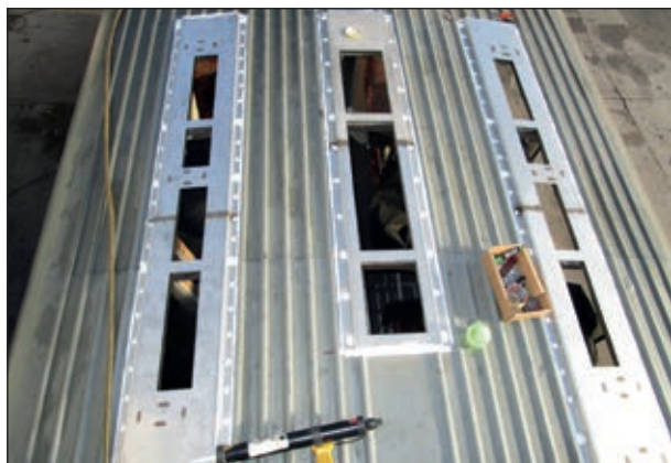
2. ábra: Tetőegység beépítés előkészítése
