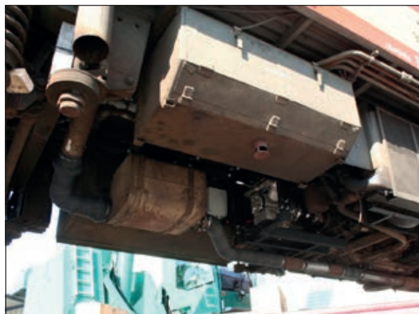
10. ábra: Hűtőkompresszor elhelyezés és segédüzemi hajtás (2)
