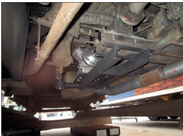
9. ábra: Hűtőkompresszor elhelyezés és segédüzemi hajtás (1)
