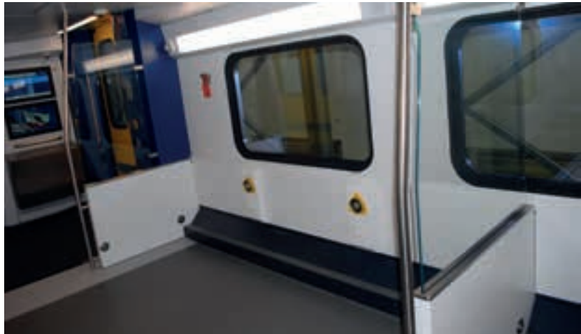
8. ábra: Akadálymentes többcélú utastér kapcsolata a bejáráthoz (Fotó: Kovács Károly) 8. Barrierefreier Mehrzweck-Fahrgastraum – Anschluss zu dem Einstieg (Aufnahme: Kovács Károly)
