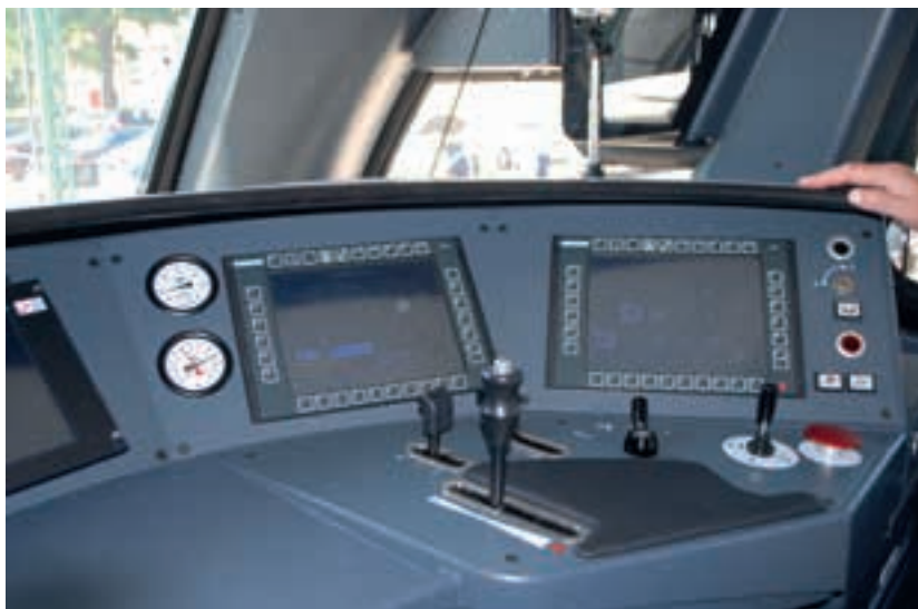
14. ábra: A vezetőfülke a vezetőpulttal (Fotó: Kovács Károly)
