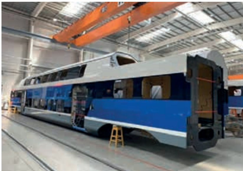
2. ábra: Készülő jármű alapozva, és készre fényezve Minkszben (Fotó: Dr. Kormányos László) 2. Wagen in Fertigung – grundiert und (fertig)lackiert, in Minsk (Aufnahme: Dr. Kormányos László) Fig. 2. Underlined and painted. Under production in Minsk (Photo: Dr. László KORMÁNYOS)
