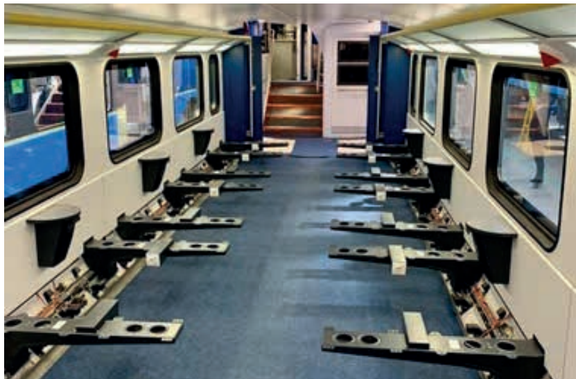
4. ábra: Járműszerelés a KISS utastérbe ülésbeépítés helyével (Fotó: Dr. Kormányos László) 4. Fahrzeugmontage im KISS-Fahrgastraum – Sitzeinbau (Aufnahme: Dr. Kormányos László) Fig. 4. Assembling of the a KISS passenger saloon with seats (Photo: Dr. László KORMÁNYOS)
