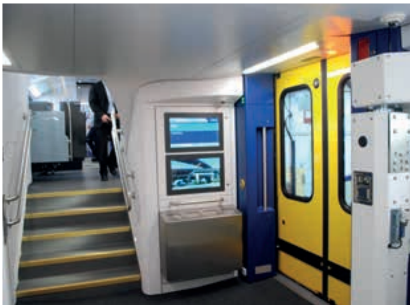
6. ábra: Beszállóajtó és az akadálymentes utastér részlete (Fotó: Kovács Károly) 6. Einstiegstür und Detail mit barrierefreiem Fahrgastraum (Aufnahme: Kovács Károly) Fig. 6. Entrance door and obstacle free passenger saloon (Photo: Károly KOVÁCS)
