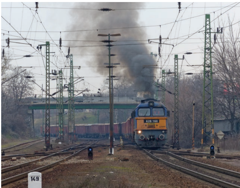
16. ábra: Dunakeszi példa a felsővezeték alatti dízel vontatás környezetkárosító hatásairól
