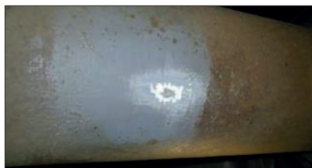
5. ábra: Tipikus felületi hibák, ideiglenesen javítva a Depóban.
