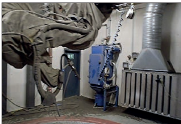
8. ábra: Szárazjeges tisztítás (automatizált)
