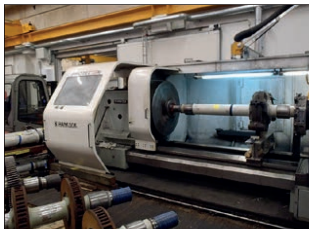
10. ábra: Felületi hibák javítása esztergagépen.
