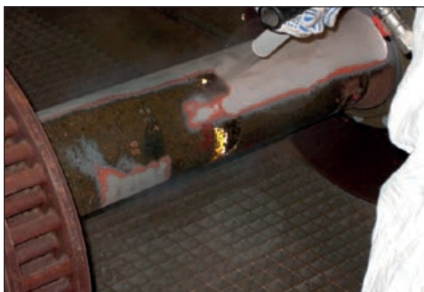
7. ábra: Szárazjeges (kézi) tisztítás
