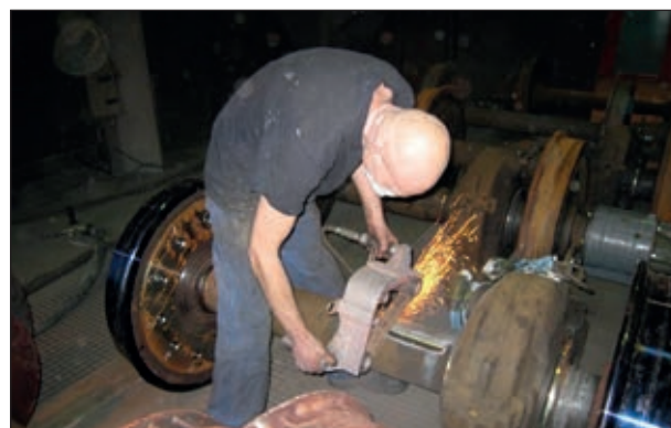
6. ábra: Festés eltávolítása szalagcsiszolóval.
