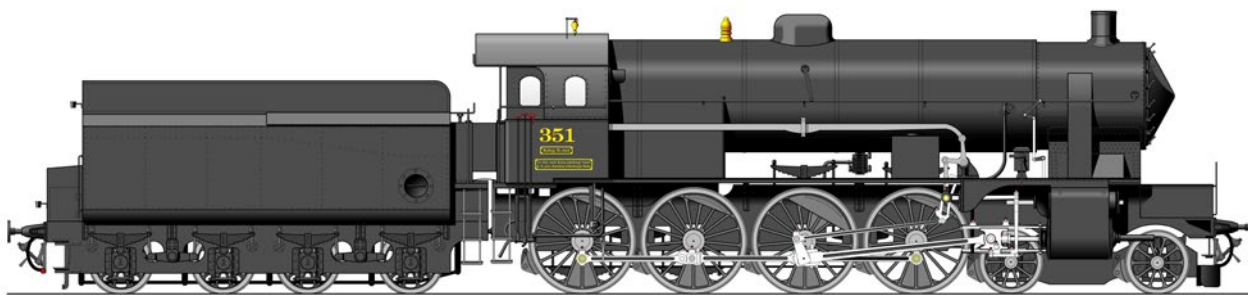
11. ábra A KsOd It. osztályú, 2'D-tengelyelrendezésű, gyorsvonati mozdonya. 1918
