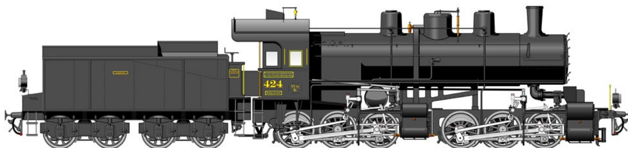
8. ábra A KsOd VIm. osztályú, C'C-tengelyrendezésű, kompaund gépezetű Mallet-rendszerű gőzmozdonya, a MÁV Gépgyár S34 jellegű, négytengelyű szerkocsijával. 1912
