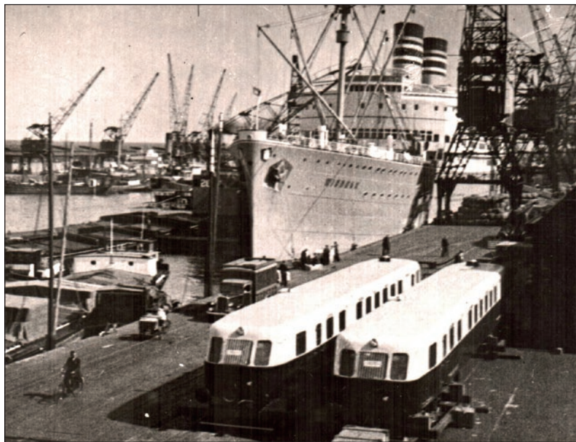
8. ábra A spanyolországi Hierro del Norte vasúttársaság megrendelésére gyártott Árpád rendszerű motorkocsi. Hamburgban vár behajózására
