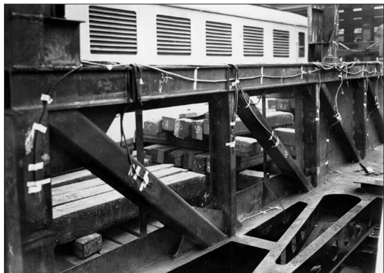
17. ábra: A DVM3 oldalfal rácsszerkezete
