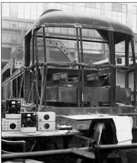
16. ábra: Terhelési próba a DVM3 vázszerkezete
