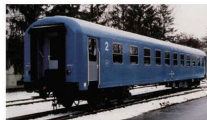
14. ábra A személyszállító járművek szekrénye - az 1991-től bevezetett RAL színskála szerinti je-löléssel - a villamos vontatójárműveknél alkalmazott RAL 5009 árnyalatú azürkék. A kocsik oldal-falán, az ablakok alatt végigfutó 500 mm széles 7038 RAL számú szürke csík a nemzetközi forgalmú, expressz- és gyorsvonati kocsik megjelölésére szolgál.
