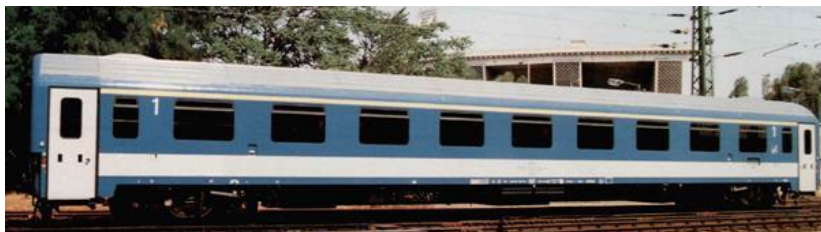
14. ábra A személyszállító járművek szekrénye - az 1991-től bevezetett RAL színskála szerinti je-löléssel - a villamos vontatójárműveknél alkalmazott RAL 5009 árnyalatú azürkék. A kocsik oldal-falán, az ablakok alatt végigfutó 500 mm széles 7038 RAL számú szürke csík a nemzetközi forgalmú, expressz- és gyorsvonati kocsik megjelölésére szolgál.
