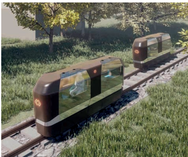
9. ábra: Monocab egy vágány egyik sínszálán halad és két sínszálon keresztezik egymást.
