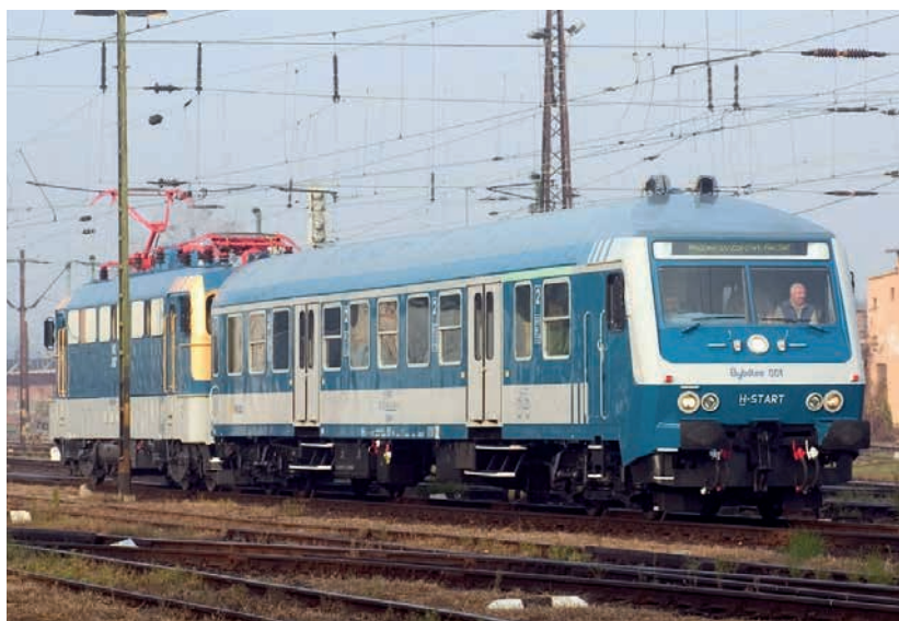
1. ábra: Az első V43-3000 sorozatú mozdony a Bydtee 80-55 sorozatú vezérlőkocsival
