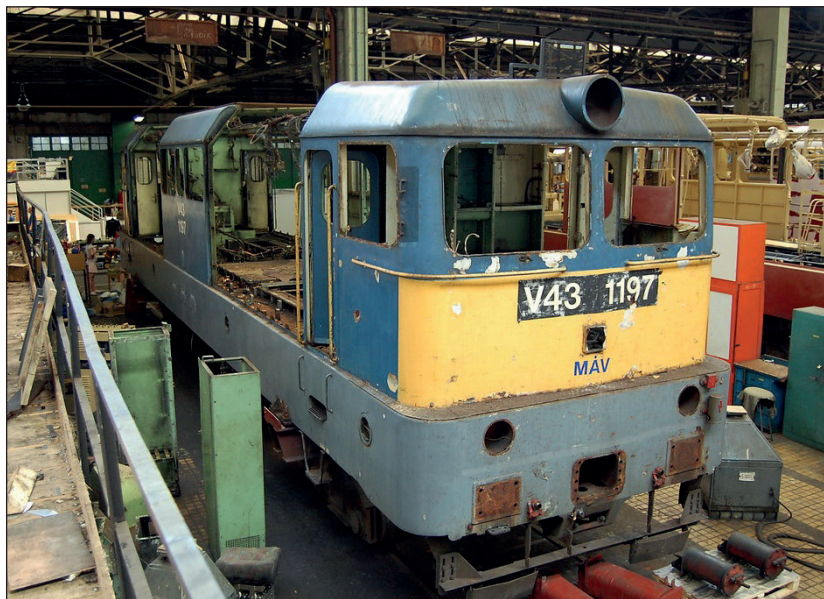
3. ábra: Északi V43-as nagyjavítása
