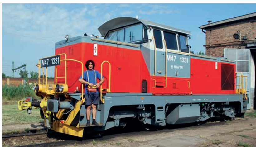
10. ábra: A Vasútgépészet 2011. évében a tartampróba után vizsgára előkészített rádiós távirányítású M47-es tolatási próbán. A mozdonyvezető a lépcsőn állva vezeti a mozdonyt Dunaújváros vontatási telepen. (Fotó: Kovács Károly)
