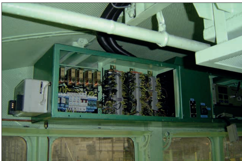
4. ábra: M44 FF rádió-relésezekrény és akkumulátortöltő
