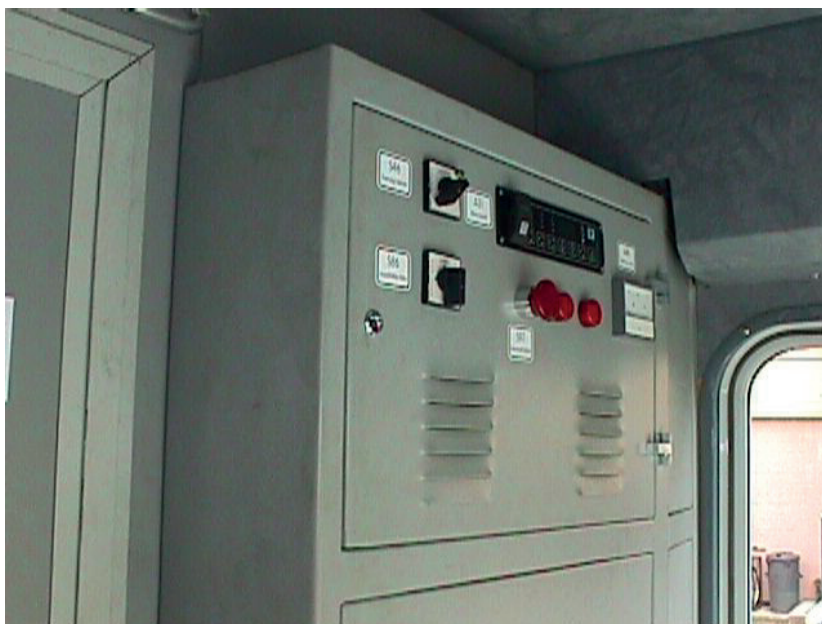
9. ábra: A villamos szekrény a vezetőállás hátfalán található
