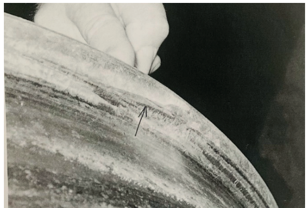
5. ábra: A féksaruból adódó ütésnyom látszik a kerékpár nyomkarimáján
