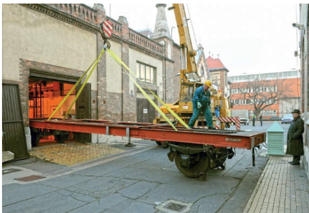
16. ábra. A mérőkocsi alvázának kiemelése a tanszéki laboratóriumból (2016. december)
