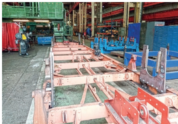
17. ábra. A mérőkocsi megfordított alváza a szolnoki üzemben az új ágyvezetékekkel és új rugótámokkal, valamint a metró vonókészülék fogadó egységével.
