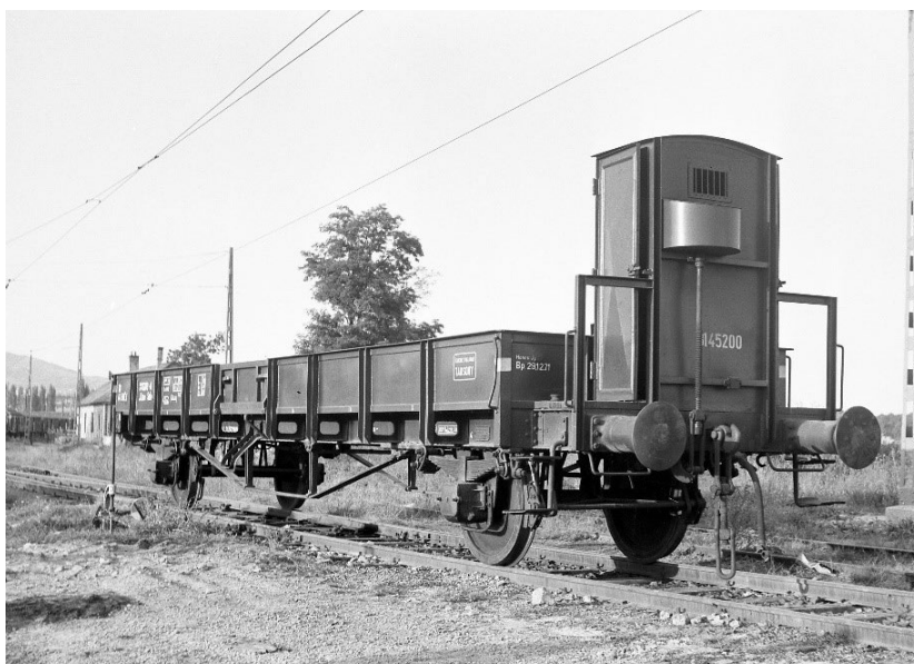
3. ábra. A mérőkocsi alapjául szolgáló, átalakított kéttengelyes teherkocsi (Lovász György)
