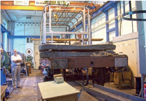
8. ábra. A mérőkabin vázszerkezete az alvázon a tanszéki laboratóriumban (a képen Professzor úr és Szél József tanszéki lakatos)
