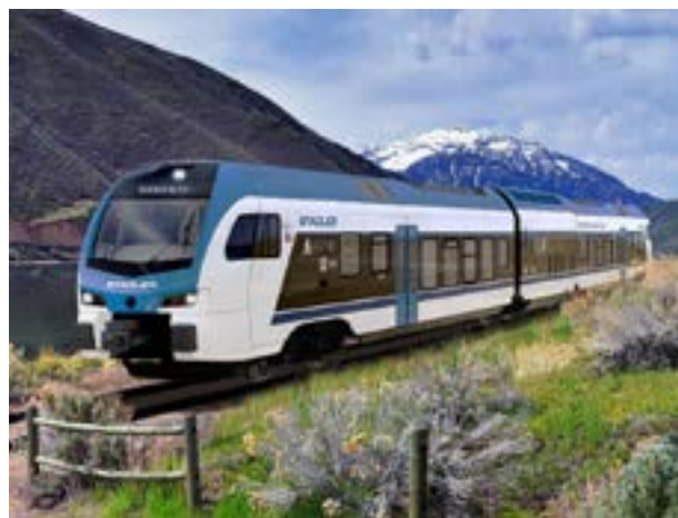
6. ábra: A fotón egy 2020-ban világsúcstartó 244 km-t utántöltés nélkül, klímával max. 140 km/h sebességgel közlekedni képes USA-nak gyártott FLIRTakku látható (Forrás: Stadler)
