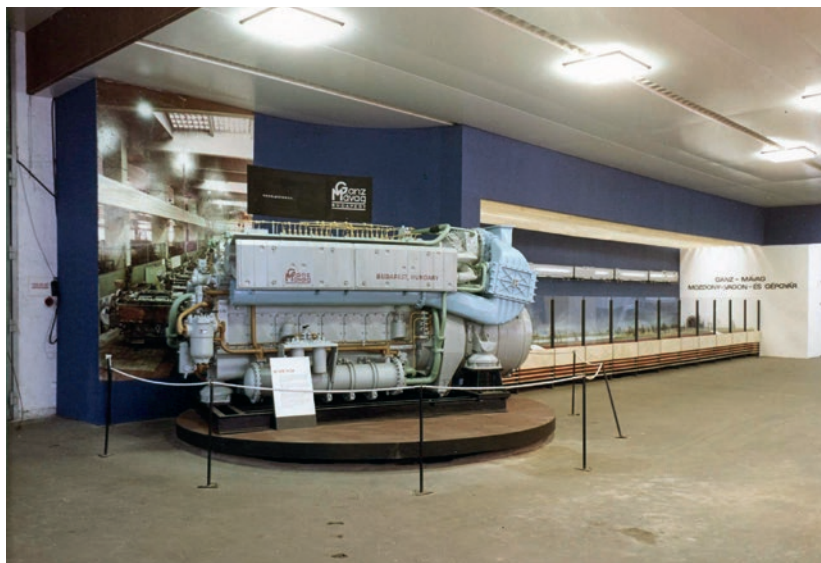
8. ábra: A 16VFE 17/24 típusú pulse converterrel és BBC VTR 250 turbófeltöltővel felszerelt dízelmotor
