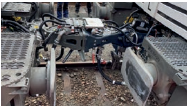
1. ábra: Két mozdony összekapcsolása digitális központi ütköző és vonókészülékkel DAC-al
