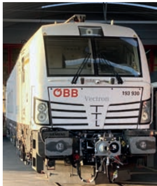
2. ábra: Az ÖBB 193 930 pszú. Vectronra szerelt DAC
