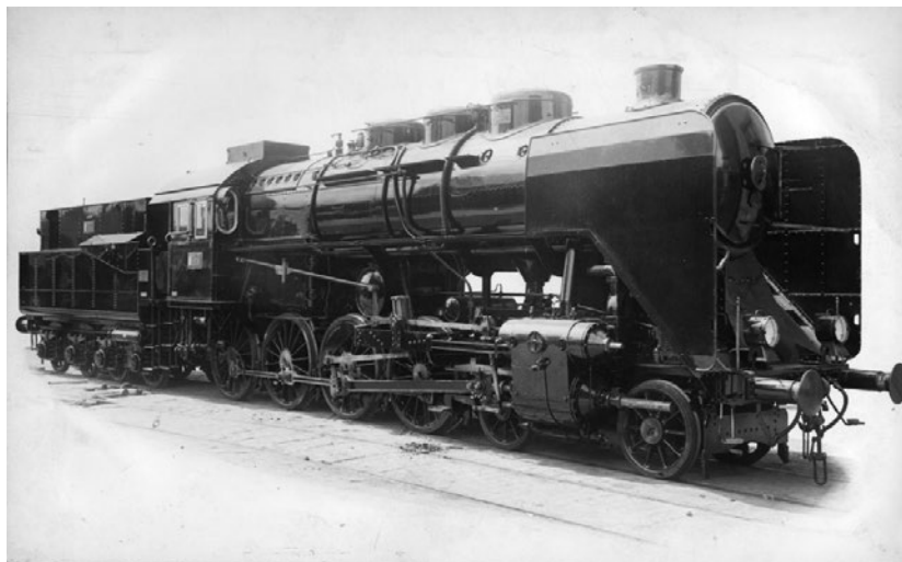
16. ábra A 424,126 pályaszámú mozdony, szegecselt füstterelő lemezekkel felszerelve. (Fotó: V&M Egly archív) 21
