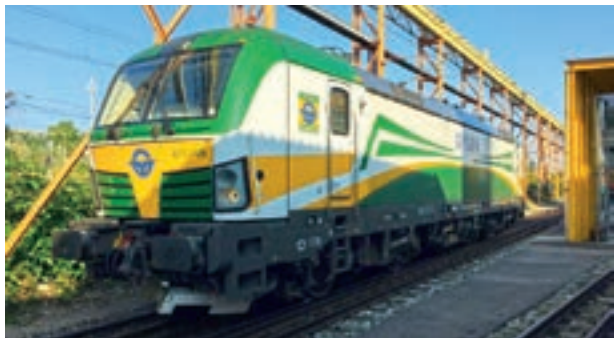
2. ábra: Vectron hibrid villamos-dízelmotoros mozdony a GYSEV tulajdonában 2018-tól. (Forrás GYSEV)
