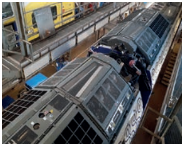
11. ábra H2 üzemanyag cellák – légkompresszorok:
