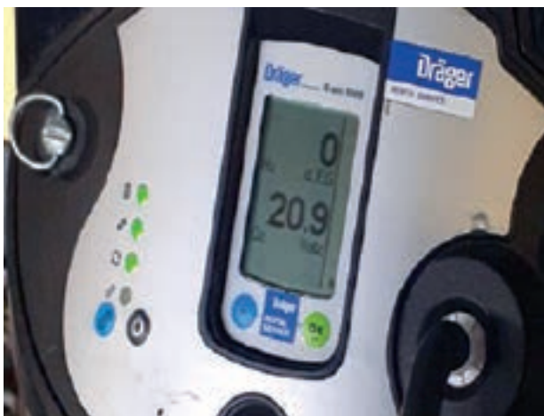
22. ábra: H2 szivárgást érzékelő adatokkal
