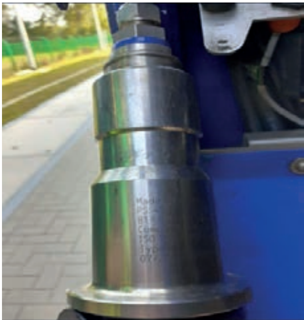
20. ábra: vasúti jármű H2 töltő csatlakozó
