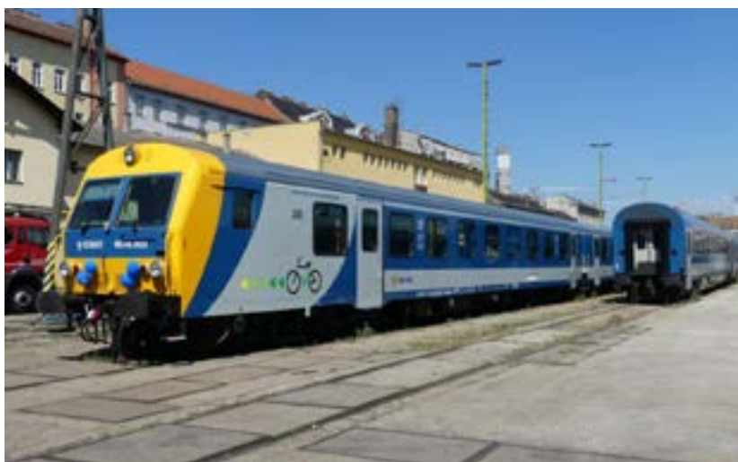
10. ábra: Schlieren vezérlőkocsi. A távvezérlési funkció nem került honosításra, így ezek a kocsik csak vontatva közlekedhetnek. (fotó: Murárik László)
