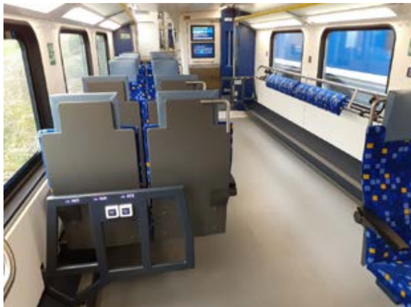
6. ábra: KISS motorvonat kerékpárszállításra alkalmas utastere az elektromos kerékpárok töltésére alkalmas aljzatokkal
