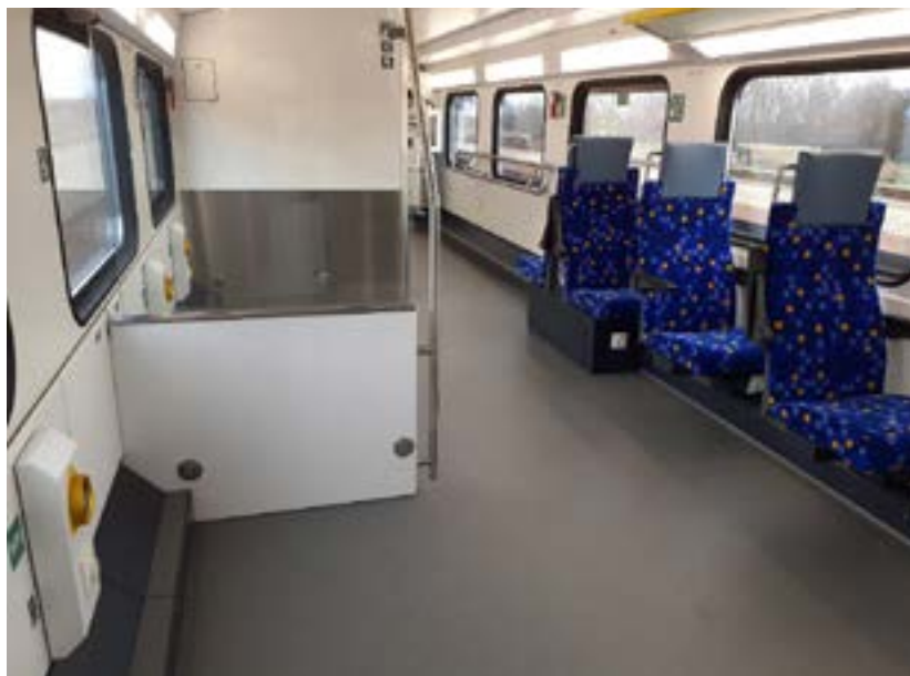
5. ábra: KISS motorvonat kerekesszékes utasok számára kialakított utastere. Jelenleg már külön elhelyezés jár a mozgásukban korlátozottaknak és a kerekpároknak, régebben elegendő volt egyetlen többcélú tér.
