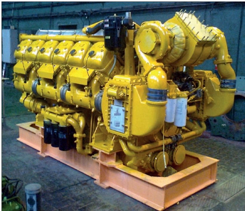
22. ábra: M41.2126 pályaszámú mozdony CR dízelmotorja
