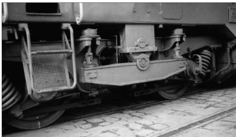
8. ábra: DHM7-1 forgóváz fényképe, ferderugós billenő
