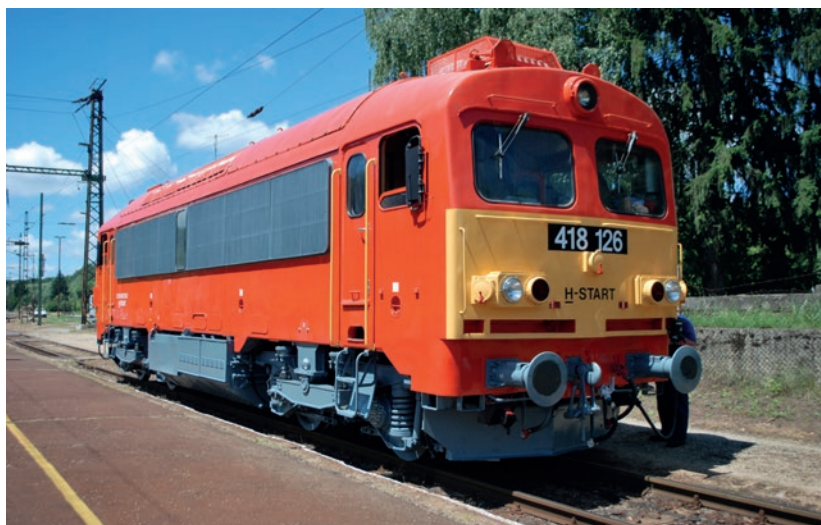
5. ábra: a MÁV-START Zrt 418 126 pályaszámú III.B emissziósra fejlesztett Ganz-Motor kft felújítású mozdony (Fotó: Kovács Károly)
