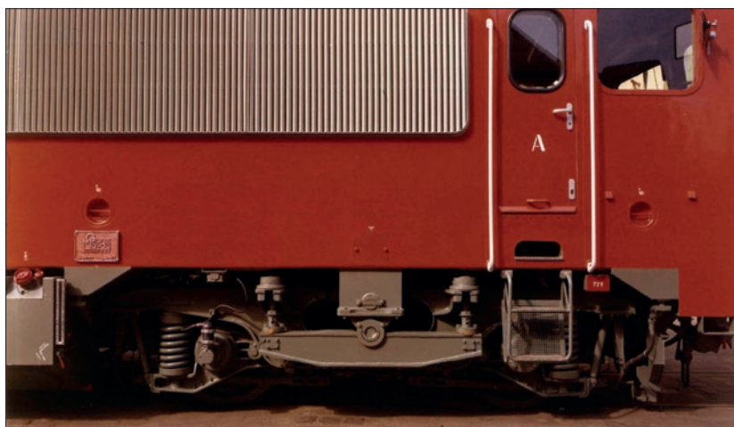
9. ábra: DHM7-1 forgóváz fényképe, egyenrugós billenő
