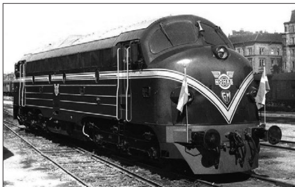
5. ábra: A fotón a Norvég Di3.623 dízel-villamos mozdony bemutatómozdonyként Budapest-Nyugati pályaudvaron 1960. májusban (tengelyrendezés: Co'Co', 105 km/óra, 1900 LE-s EMD 16-567C dízel-motor, gyártó a svéd NoHAB Trollhättanban 1960-ban, fotó: digitalmuseum.se)
