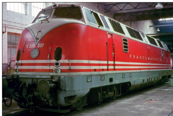
10. ábra: Az ML3000 típusú 3000 LE-s dízelmozdony
