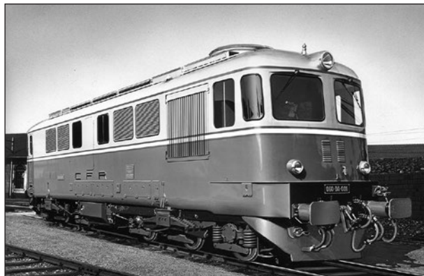
7. ábra: A román vasút a licenciában is gyártott 2100 LE-s dízel-villamos mozdonyát 1959-től szerezte be
