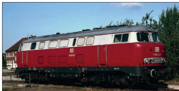
8. ábra: A Német Szövetségi Vasutak egymotoros, 1900 LE teljesítményű, hidraulikus hajtásrendszerű, 120 km/h legnagyobb sebességű dízelmozdonya
