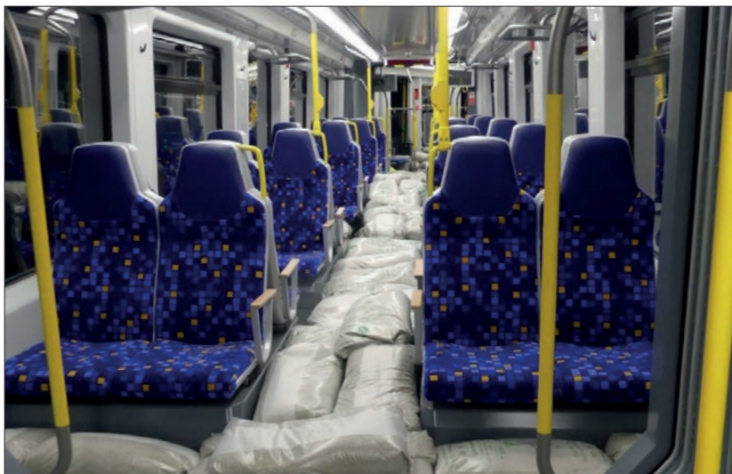
12. ábra: Fékűtmérésre készen homokzsákokkal megterhelt tram train (Fotó: Murárik László)
