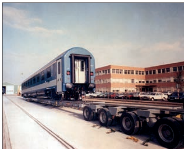
4. ábra: Az 1. osztályú fülkés kocsi Zaragozából trélerrel átszállítás előtti felrakódása Irun-ba átszállítás miatt (fotó: CAF)
