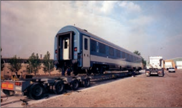
5. ábra: Az 1. osztályú fülkés kocsi felrakásának helyszíne: Zaragoza. A közúti szállítás szükségessége: a RENFE és a MÁV nyomtávjai közötti eltérés. Megközelítőleg 1994 közepétől vendégforgóvázon történt a szállítás Zaragoza és Irun valamint Beasain és Irun között (Fotó: CAF)
