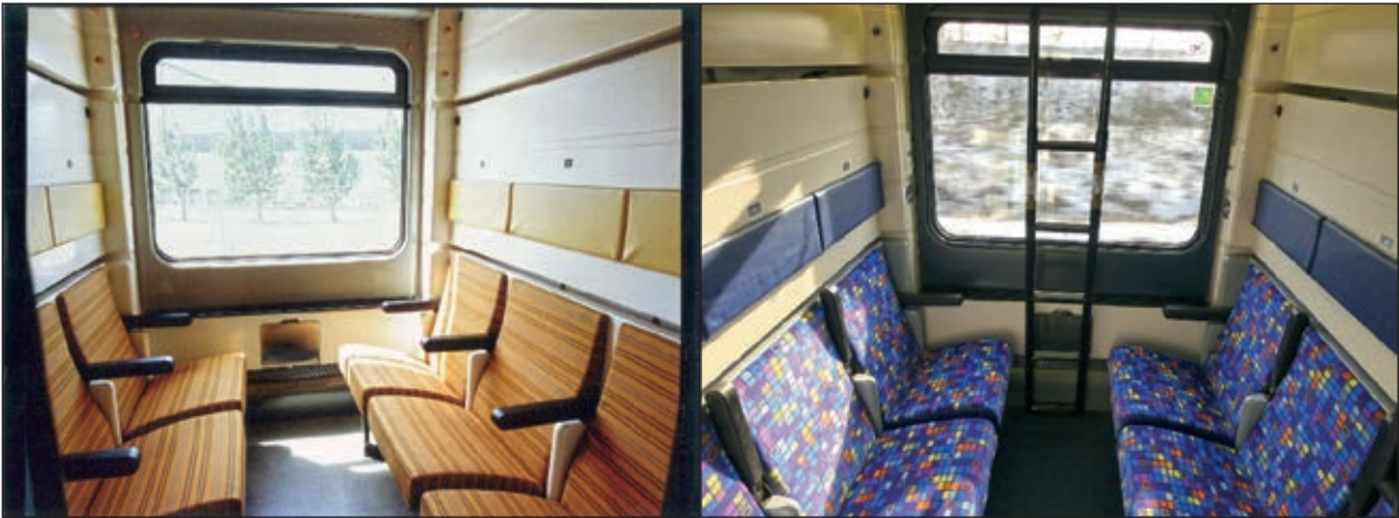
18. ábra: 50-91-es CAF fekvőhelyes kocsi eredeti/felújított állapotban (Fotó: CAF/Murárik László)
