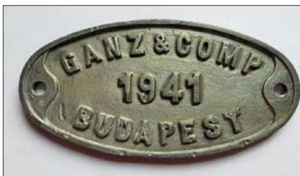
8. ábra: A Ganz gyár által szállított WIFO tartálykocsikra ilyen gyártási táblákat szereltek. Ezt a gyártási táblát az SNCF-től 1947-ben „visszaszerzett” 595535, majd MÁV Ráfű 7503260, 1967 után 20 55 703 7502-7, majd 20 55 716 0537-2, végül 30 55 707 2002-2 pályaszámú tartálykocsi viselte 1992 évi selejtezéséig. (Dr. Lovász György gyűjteménye)
