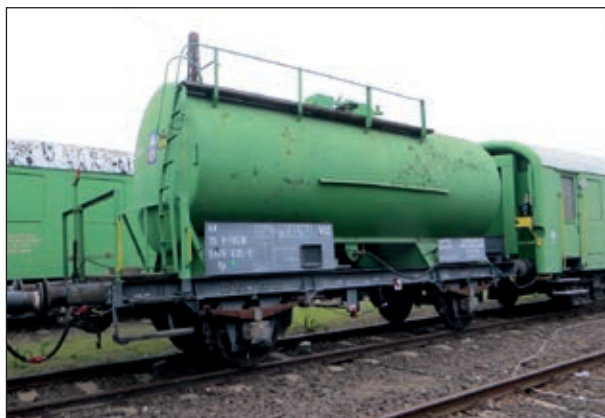
6. ábra: Mialatt két „testvére” Székesfehérváron megszépült, a harmadik a Biatorbágy – Herceghalom között folyó pályafelújítási munkákhoz a főváros közelébe diszponált munkavonatok vízellátását biztosította. A ma 44 55 947 8635-9 pályaszámú kocsi is eredeti német siklócsapággal közlekedik. Ez év tavasza óta tudjuk, hogy eredetileg a WIFO 923638, majd az SNCF 595698, majd a MÁV Rfu 7507319 később 20 55 705 0138-2 majd 30 55 707 6094-9 pályaszámú kocsija volt. Ganz gyártási száma: 82048. (fotó: Dr Lovász György, Ferencváros 2024 január.)
