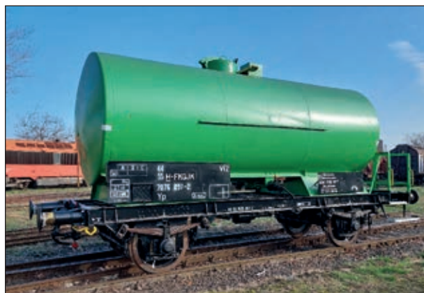
4. ábra: 82 éves korában kifogástalan állapotban van a Székesfehérváron szintén 2024 márciusában fővizsgált egykori 923518-as pályaszámú tartálykocsi is. 1945 után SNCF 595689, majd MÁV Rfu 7507322, 1967 után 20 55 705 0141-6, jelenleg pedig 44 55 707 6097-2 pályaszámot visel. Érdemi korszerűsítésként MÁV 12-es görgőcsapágyakat kapott. Gyártási száma: 81928. (Fotó: Bognár Balázs, 2024 március)
