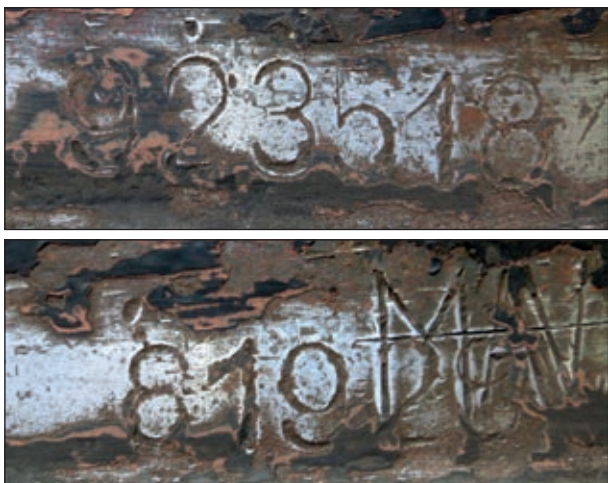
5. ábra: A fenti 44 55 707 6097-2 pályaszámú tartálykocsi alvázában megtalált eredeti Ganz gyártási szám és első DR illetve WIFO pályaszám (Fotó: Dr. Lovász György)
