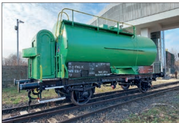
3. ábra: A fenti kocsi közeli testvére, az egykori WIFO 923500-os 2024 márciusában Székesfehérváron, a MÁV Vagon Kft.-nél fővizsgált. A háború viharait megjárt kocsi SNCF 595686, majd MÁV Rfu 7507317, 1967 után 20 55 705 0136-5, majd üzemi kocsiként 30 55 707 6095-6, végül napjainkban, az FKG tulajdonában 44 55 947 8636-7 pályaszámmal üzemel. A képen jól megfigyelhetők a tartály „foltoszos javításának” nyomai, melyek minden bizonnyal a II. világháború során történt lövések okozta sérüléseket hivatottak elfedni.
