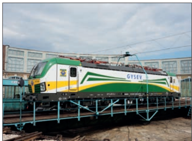
2. ábra: A GYSEV hibridje, az utolsó mérőföldben dízelként üzemelő Vectron (Fotó: GYSEV)
