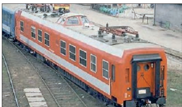
17. ábra: Az egykori MÁV FKI által üzemeltetett felsővezetékvizsgáló Nautilus mérőkocsi fotója (Fotó MÁV FKI)
