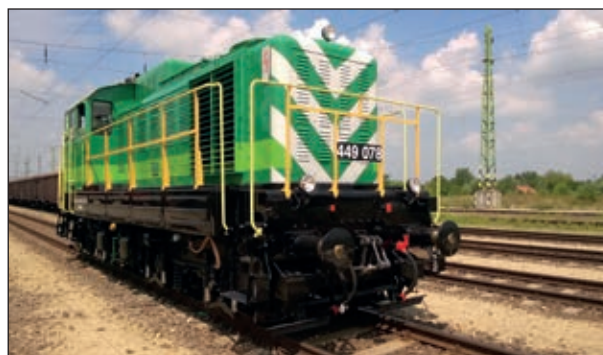
16. ábra: A régi, Ganz-MÁVAG által gyártott M44 mozdony korszerűsített CammonRail motoros „zöld” dízelmozdonya (Fotó: Ganz Motor)
