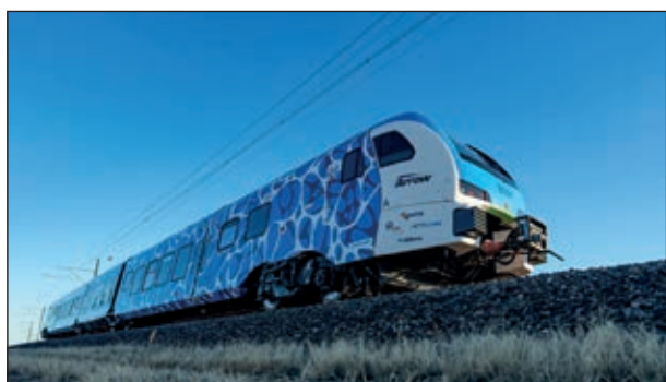
13. ábra: A világsúcstartó FLIRT H2, alkalmas a dízel motorvonatok kiváltására és egy napig újra töltés nélkül működni képes. (Fotó Stadler)
