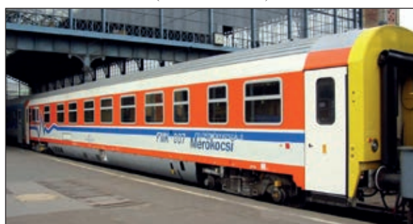
18. ábra: Az egykori MÁV FKI által tervezett, az építésben közreműködő 2004-ben még új FMK007 mérőkocsi fotója (Fotó: MÁV FKI)
