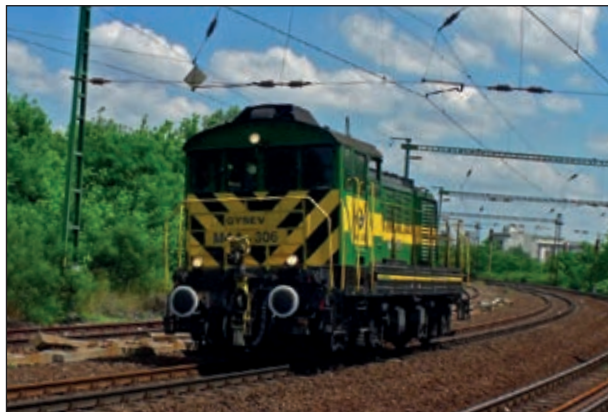
4. ábra: A GYSEV M44 306 volt az első magyar rádiós távirányítású, és „geleta kimélő” mozdonya (Fotó: Előhegyi István)
