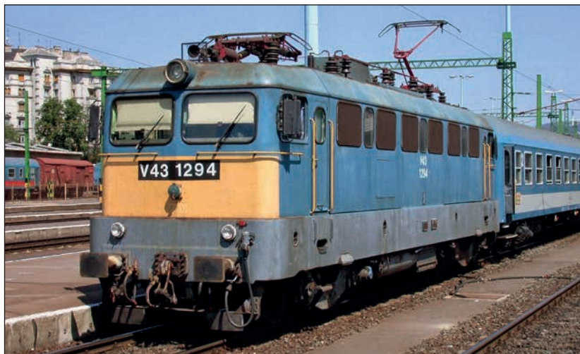
1. ábra: Az Afp 221 típusú áramszedős V43-as a korszerűsítés része
