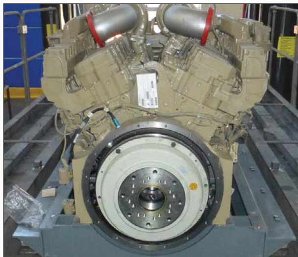
14. ábra: Tartókeretre épített dízelmotor Рис. 14.: Дизель-двигатель на опорной раме Figure 14.: Diesel motor installed on holder frame
