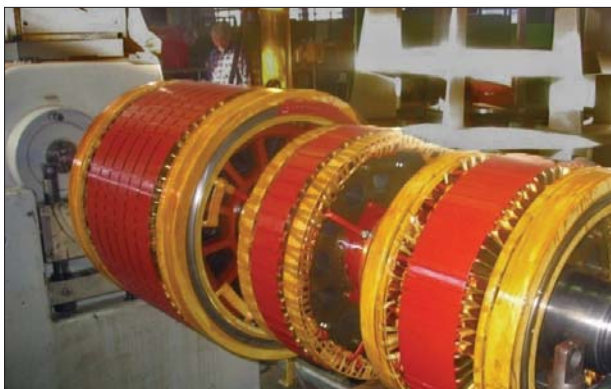
5. ábra: Tandem generátor forgórész Puc. 5.: Ротор тандемного генератора Figure 5.: Tandem generator rotor
