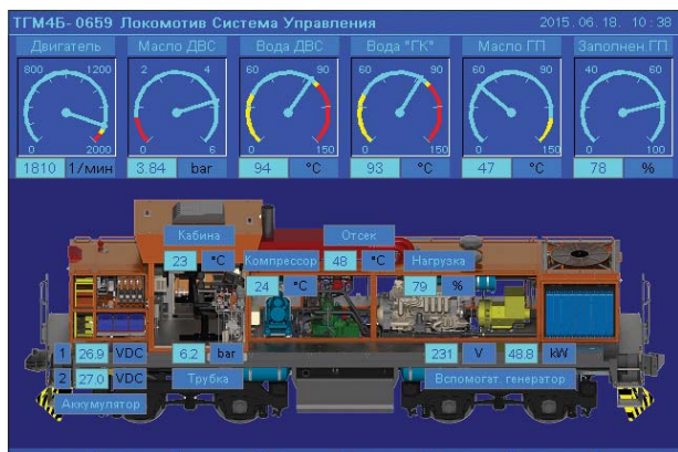
18. ábra: TGM4B mozdony megjelenítő monitor oldal Рис. 18.: Страница монитора наблюдения тепловоза ТГМ4Б Figure 18.: Picture of monitor display in driver's desk of TGM4B
