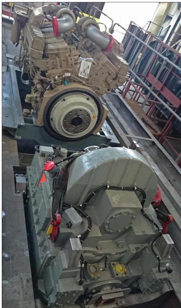
15. ábra: A hajtómű és a dízelmotor beépítési fázisa Рис. 15.: Гидропередача и дизель-двигатель Figure 15.: Installation phase of hydraulic power unit and diesel motor
