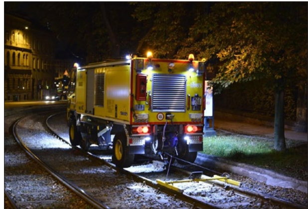
10. ábra: Hullámos kopásmérés a RailSurf mérőműszerrel
