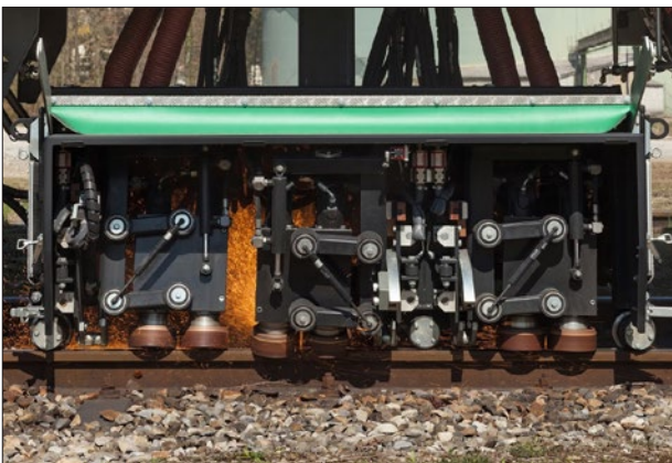
6. ábra: Kettős csiszolótengelypárok csiszolás közben (szikrafogólemez nélkül)
