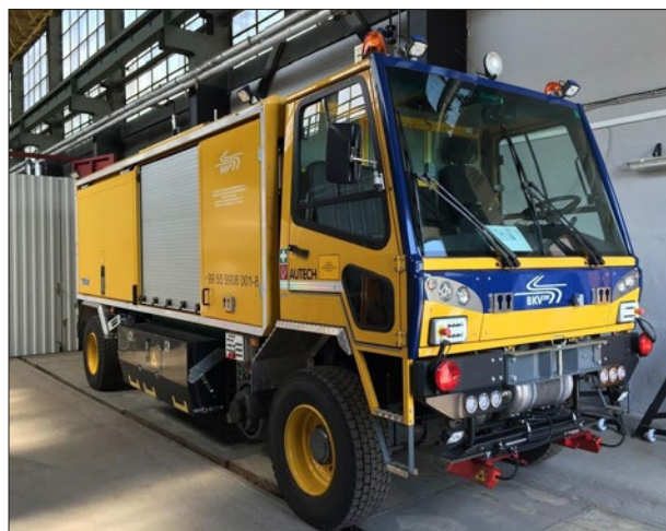
3. ábra: Az AT VM 8000-12 E típusú síncsiszoló jármű a BKV Zrt. telephelyén
