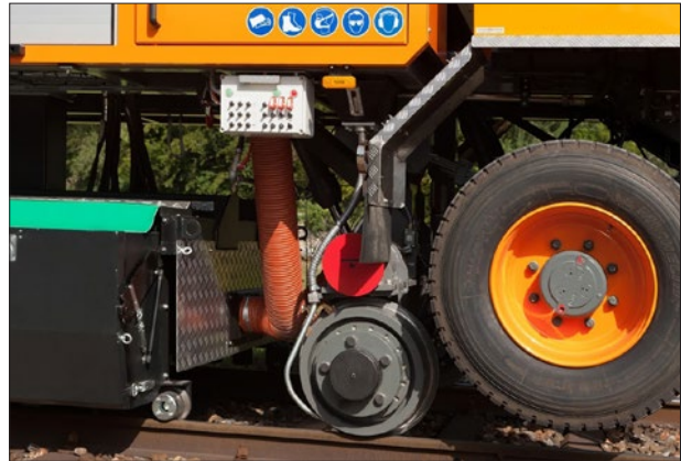
5. ábra: Vasúti kerék homokszóró berendezéssel
