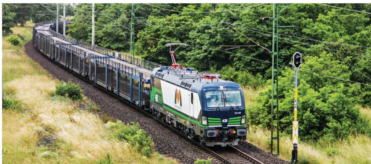
6. ábra: Az MMV ZRt egy a legkorszerűbb Siemens Vectron mozdónnyal továbbított tehervonata Abb. 6: Ein durch die modernste Siemens Vectron Lokomotive der MMV ZRt beförderte Güterzug Fig 6: Freight train of the MMV Co. headed by a most modern Siemens Vectron electric locomotive
