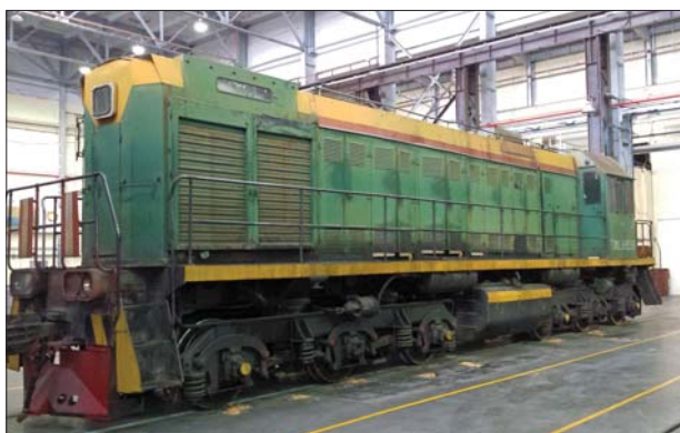
1. ábra: A TEM2 típusú dízel villamos erőátvitelű tolatómozdony Fig: 1 TEM2 diesel-electric shunting locomotive Фото 1: Дизель-электрический маневровый локомотив типа ТЭМ2
