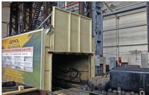
7. ábra: Forgóváz és alkatrészmosó Fig 7: Bogie and component cleaning station Фото 7: Мойка тележки и комплектующих
