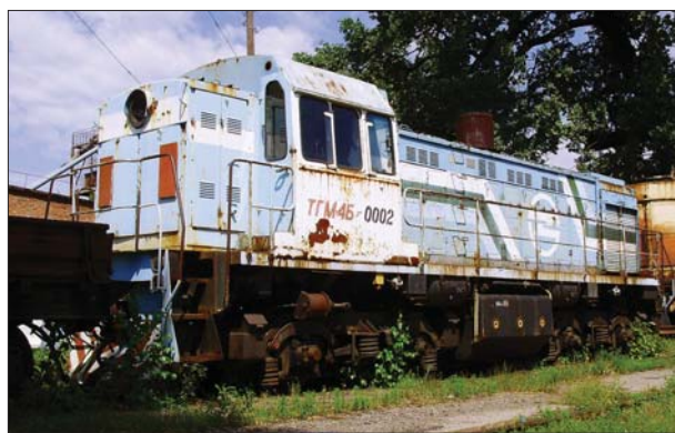
2. ábra: A TGM4 típusú dízel-hidraulikus erőátvitelű tolatómozdony Fig: 2 TGM4 diesel-hydraulic shunting locomotive Фото 2: Дизель-гидравлический маневровый локомотив типа ТГМ4
