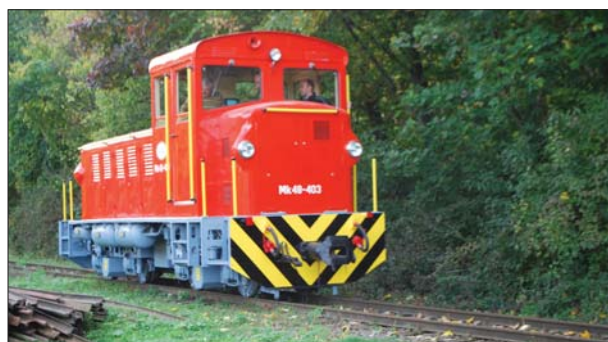
24. ábra: SzÁEV Mk 48 403 dízel-akkumulátoros mozdony
