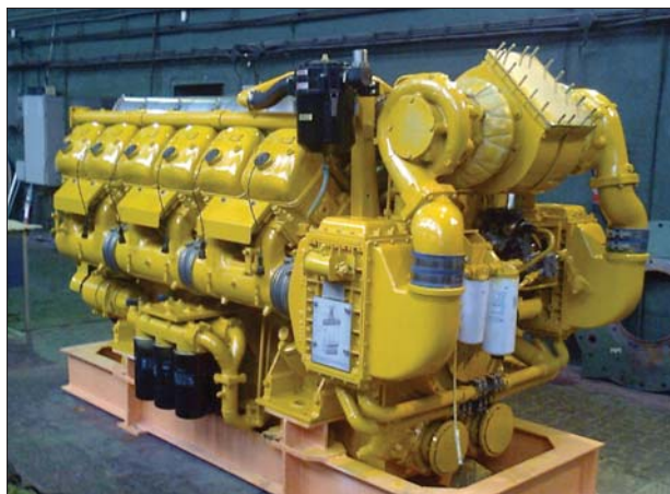
6. ábra: A III.B. káros anyag kibocsátású 12 hengeres Ganz CR dízelmotor
