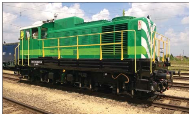
22. ábra: A Ganz Motor Kft-ben gyártott környezetbarát CR dízelmotoros MOL dízelmozdony a Szolnoki járműjavítóban lett felújítva.
