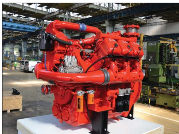
5. ábra: A III.B, káros anyag kibocsátású hat hengeres Ganz CR dízelmotor
