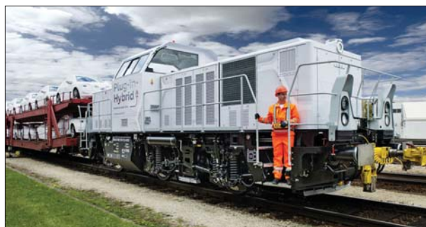
3. ábra: H3 rádiós távirányítású tolatómozdony
