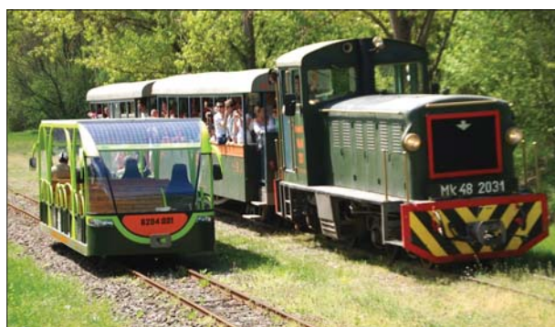
25. ábra: A 8204 pályaszámú napelemes akkumulátoros hibrid motorkocsi
