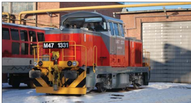
21. ábra: Az M47 1331 pszú rádiós távirányítású III.B káros anyag kibocsátású dízelmozdony
