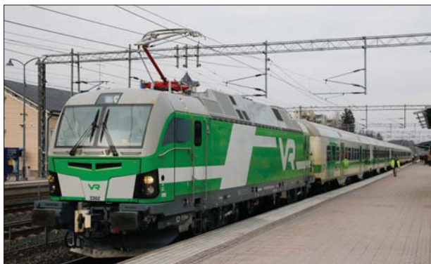
10. ábra: A Siemens Vectron skandináv északi éghajlati viszonyokra áttérveze
