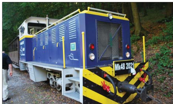
23. ábra: LÁEV Mk 48 2021 dízel-akkumulátoros mozdony
