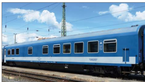
22. ábra: A németországi Ammendorfben épült 160 km/h sebességre alkalmas WRbumz 88-71 középszám csoportú étkezőkocsija (Fotó: Murárik László)
