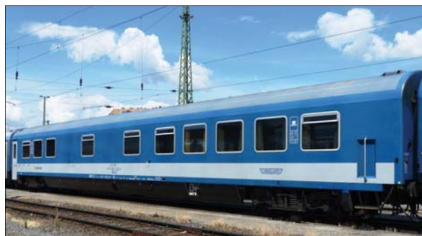
22. ábra: A németországi Ammendorfban épült 160 km/h sebességre alkalmas WRbumz 88-71 középszám csoportú étkezőkocsi (Fotó: Murárik László)
