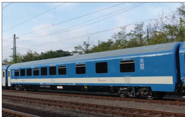
23. ábra: A spanyol CAF cég által gyártott, 200 km/h sebességre alkalmas WRMz 88-91 pályaszámú étkezőkocsi (Fotó: Murárik László)
