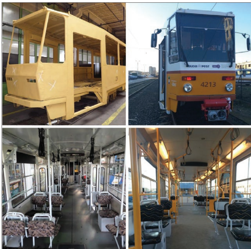
3. ábra: A villamos megújított utastere Abb. 3: Der erneuerte Fahrgastraum des Straßenbahnfahrzeugs Fig 3: The modernised passenger saloon of the tramcar
