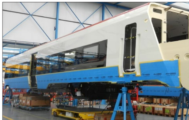
22. ábra: Az EC 250-es jármű szerelése a Stadler bussnangi gyárában Abb. 22.: Montage des EC 250-Wagenkastens im Stadler-Werk Fig. 22.: Assembling of EC 250 coach body in the Stadler factory
