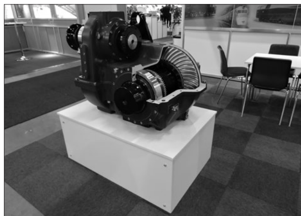
5. ábra: TKK 22,5 típusú tengelyhajtómű Abb. 5: Radsatzgetriebe Typ TKK 22,5 Fig 5. Wheelset equipped with gear unit type TKK 22.5
