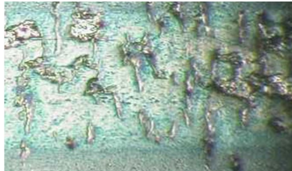
3. ábra: Előrehaladott felületi károsodás jellemző eredményei az [5] egyenletből
