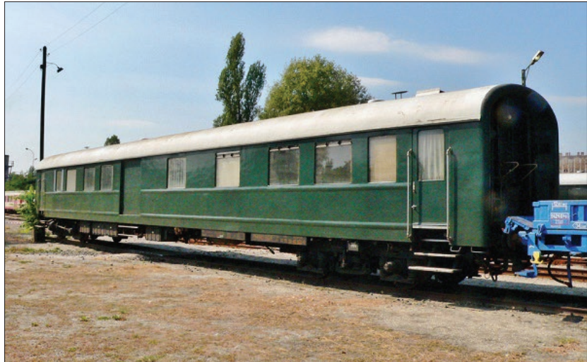
1. ábra: Az idén 100 éves 9,3 m-es forgócsaptávolságú 4 tengelyes személykocsi. A járműtípust a Vasútgépészet 2015. évi 2. számában Lovász György írásában mutattuk be. A kocsi megengedett sebessége 100 km/h volt. A képen látható Turan 12 kocsi a MÁV Nostalgie Kft vonataiban, napjainkban is közlekedik.
