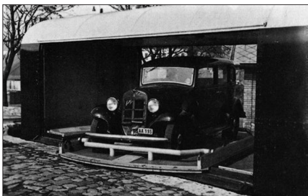
9. ábra: A Turán kocsiból oldalrakodáskor a személygépkocsi elforgatásához fordítókorongot építettek be
