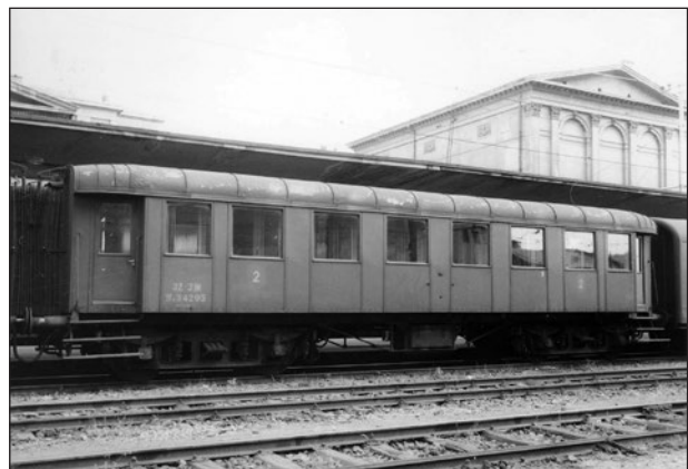
6. ábra: Az I. Világháborút követő szétosztás – JZ 34205 cserélt forgóvázal
