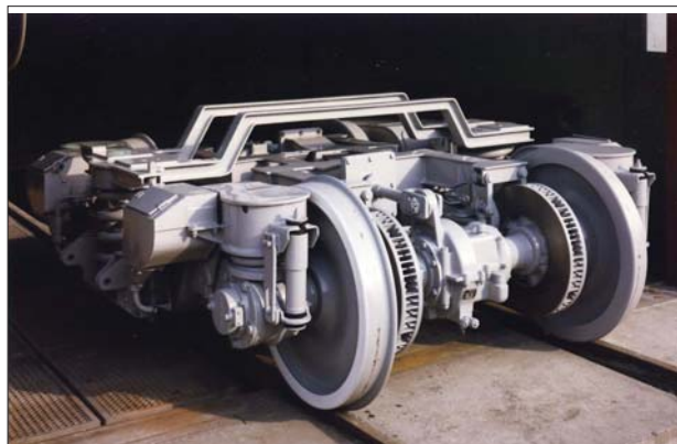
6. ábra: TÜVASAS hajtott forgóváz
