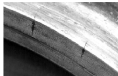
6. ábra.: Túlzott hőfeszültség okozta felszíni repedések a féktárcsán, keréken [1]
