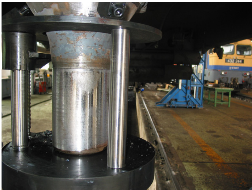
4. ábra: A forgócsap esztergáló készüléken készre munkált forgócsap
