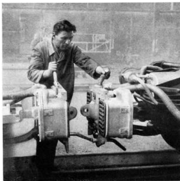
3. ábra. GANZ távkapcsolású motorkocsi központi kapcsoló készülék mechanikai, légfék- és segédáram-csatolással
