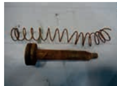
2. ábra – Korróziós károsodás a különböző szerkezeti elemeken – melyek a légszárító vezérlőkártya tönkremenetelre voltak visszavezethetők.
