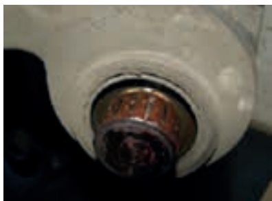
2. ábra – Korróziós károsodás a különböző szerkezeti elemeken – melyek a légszárító vezérlőkártya tönkremenetelre voltak visszavezethetők.
