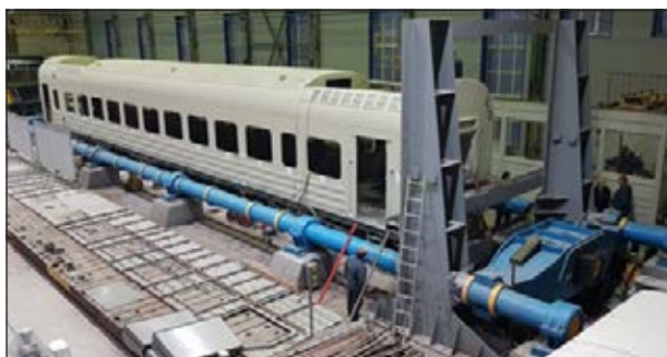
2. ábra: Járműszekrény statikus szilárdsági mérés a tveri tudományos kutatóintézet (TIV) vizsgálati laboratóriumában
