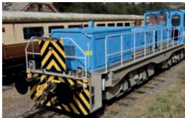
8. ábra: Az angol vasutak dízelmotoros-akkumulátoros tolatómozdonya
