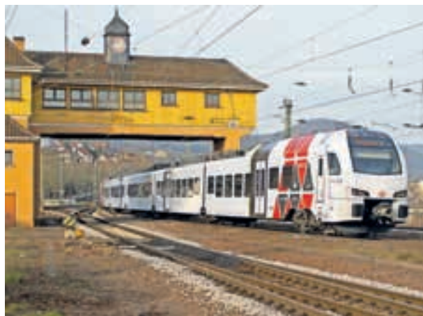
2. ábra: A STADLER akkumulátoros-villamos FLIRT a DB számára készül
