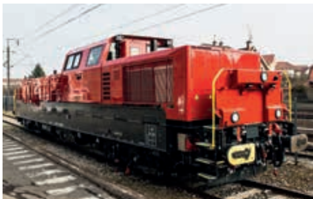
7. ábra: Az SBB számára gyártott H4 kettős erőforrási mozdony
