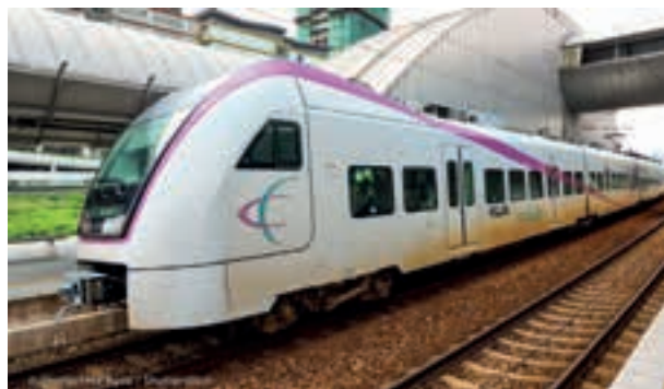
5. ábra: A KLIA Expressre az SKF Insight Rail állapotfelügyeleti rendszert építették be megbízhatóságához.
