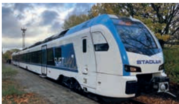
3. ábra: A Stadler akkumulátoros –dízelmotoros FLIRT szintén a német vasút számára
