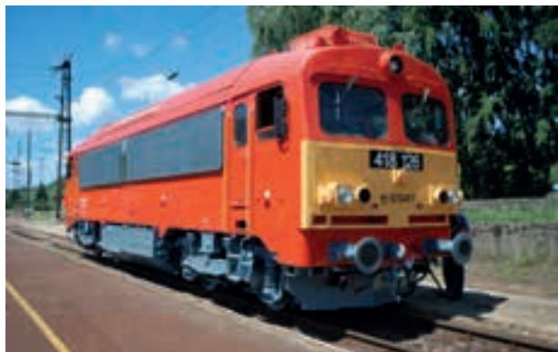
6. ábra: A MÁV-START Zrt M41-es sorozatú 148.126 pályaszámú a Ganz-MÁVAG DHM7 gyári típusjelű dízelmozdonya látható, amelybe tizenkét hengeres CR motort épített be a Ganz Motor Kft. Ezzel ez a dízelmozdony károsanyag kibocsátása a korábbi 2%-ára csökkent. Az első vonali futópróbán látható mozdonyba Dombóváron építették be az új részecskeszűrős dízelmotort.
