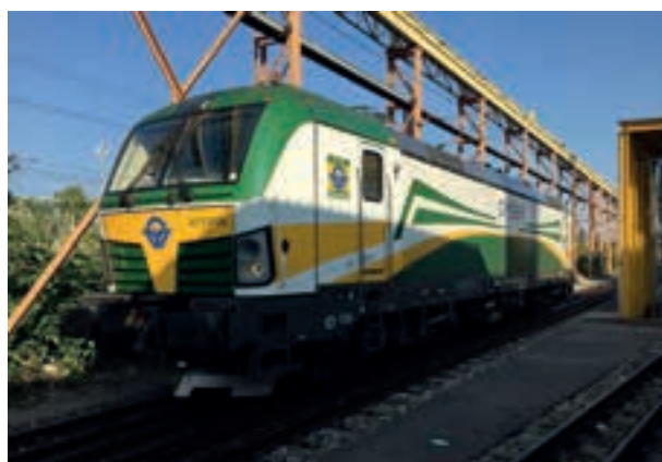
6. ábra: A GYSEV számára gyártott kettős erőforrású Siemens Vectron
