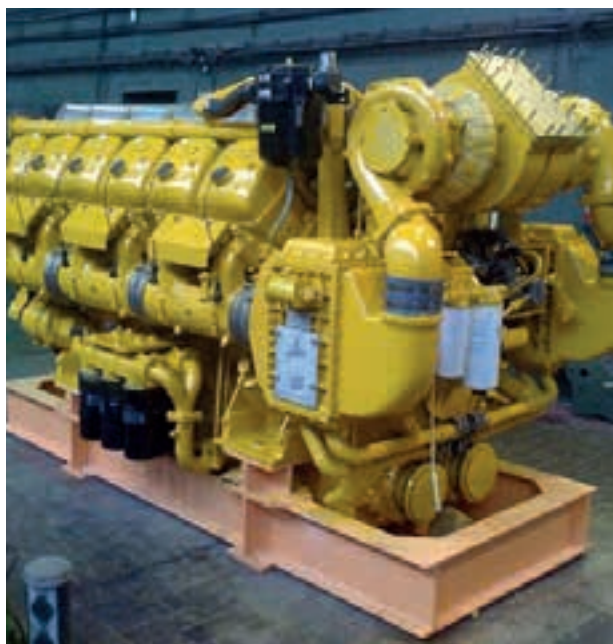
1. ábra: A MÁV M41 mozdony CR kivitelre átépített 12PA4V185VG dízelmotorja
