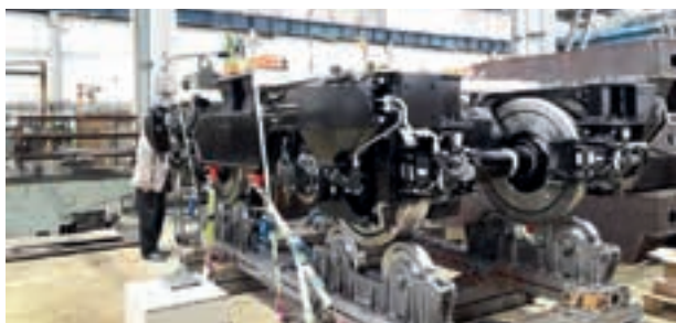
4. ábra: Görgős padon az amerikai megrendelésre gyártott hajtott forgóváz a Ganz Motor kft gyártócsarnokában
