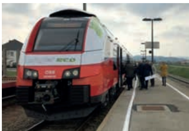
5. ábra: Az ÖBB számára gyártott Siemens, akkumulátoros-villamos Desiro ML.
