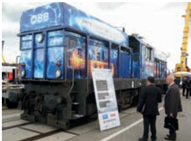
1. ábra: Az ÖBB villamos-akkumulátoros zéró emissziós tolatómozdonya 2016-ban a Berlini Innotrans kiállításon mutatkozott be
