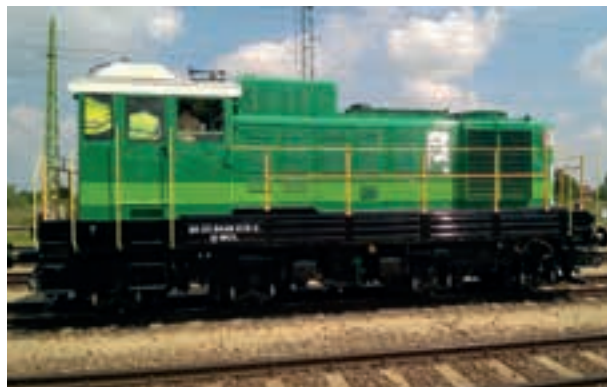
7. ábra: A MOL NYRt elhatározta, hogy az A25-ös sorozatú, Ganz-MÁVAG DVM2 gyári típusjelű dízelmozdonyait a hathengeres CR motorokkal újítja fel. A 7. ábra egy ilyen CR motorral felújított mozdony látható, sikeres hatósági járművizsgán.
