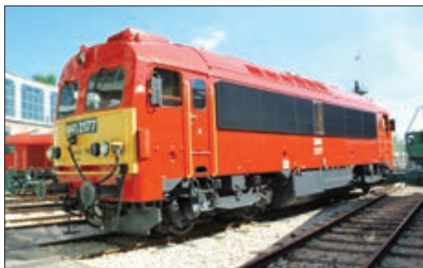
10. ábra: Az M41-eseknek motorcserével több évtizedre meghosszabbítható lesz az élettartamuk (a szerző felvétele)
