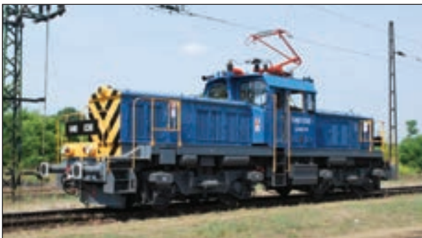
12. ábra: A V46 sorozatú villamos mozdony alkalmas modernizálásra és kettős erőforrásúra átalakításra (a szerző felvétele)
